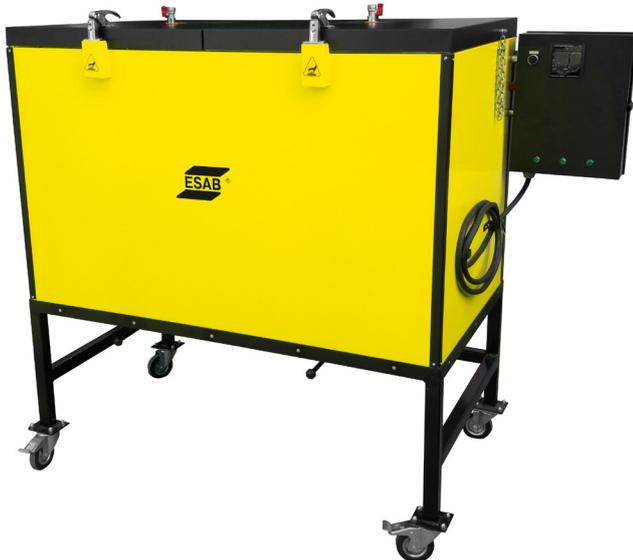
Los SDF son grandes contenedores para el secado y el almacenamiento de polvo de soldadura (fundente). Son fáciles de desplazar y cuentan con un termostato digital con un amplio rango de temperatura de almacenamiento. Tras el secado, la temperatura disminuye automáticamente hasta 130 °C (260 °F), la temperatura preestablecida de almacenamiento en seco recomendada.
