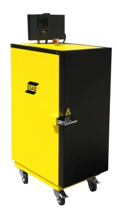
Los SDE son grandes contenedores para el secado y el almacenamiento de electrodos. Son fáciles de desplazar y cuentan con un termostato digital con un amplio rango de temperatura de almacenamiento. Tras el secado, la temperatura disminuye automáticamente hasta 130 °C (260 °F), la temperatura preestablecida de almacenamiento en seco recomendada.
