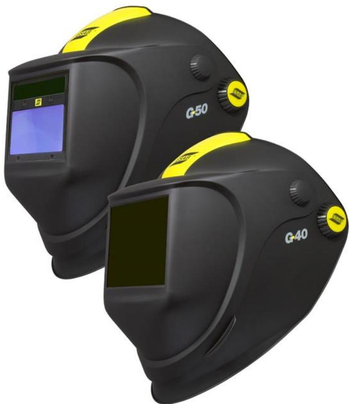
La G40 y G50 es una pantalla combinada de soldadura y pulido; la G40 incluye un cristal mineral pasivo y la G50 un filtro de oscurecimiento automático (ADF), niveles de oscurecimiento DIN 9-13 y visera abatible. La lente de plástico grande ofrece al soldador un campo de visión completo cuando la visera está plegada hacia arriba. Las pantallas disponen de la puntuación B en la clasificación de resistencia al impacto, lo que significa que están homologadas para ser utilizadas en el pulido.
