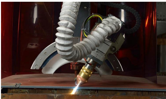
Las herramientas de plasma pueden incluir biselado por plasma automático.
