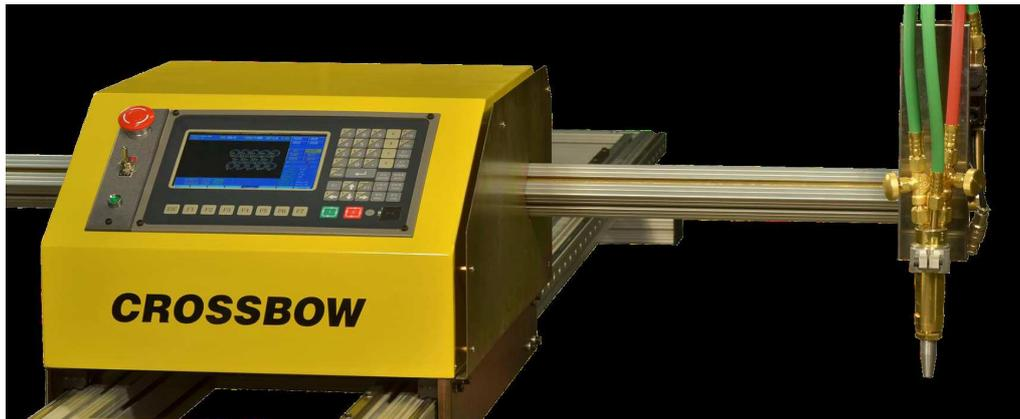
El sistema Crossbow incluye de serie un cabezal de corte por oxicorte y opcionalmente también permite instalar un plasma, permitiendo cambiar fácilmente entre ambos sistemas. Con plasma, se puede cortar hasta 20 mm de acero carbono o aluminio (dependiendo del tipo de plasma montado), o hasta 15 mm de inoxidable. Con oxicorte, se alcanzan los 100 mm de acero carbono. El interfaz, dirigido por menú en pantalla, hace que su funcionamiento sea sencillo y fácil de aprender.
