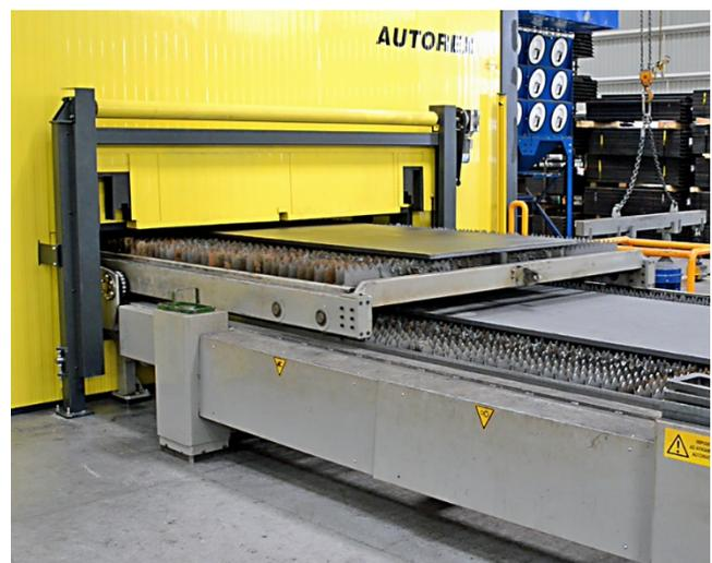
*El rápido funcionamiento del intercambio de mesas mantiene el cabezal de la máquina funcionando durante más tiempo para una productividad máxima.*
