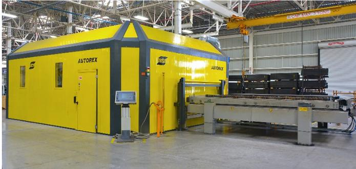
*El sistema AutoRex cierra completamente la zona de corte garantizando la máxima seguridad para los trabajadores.*
